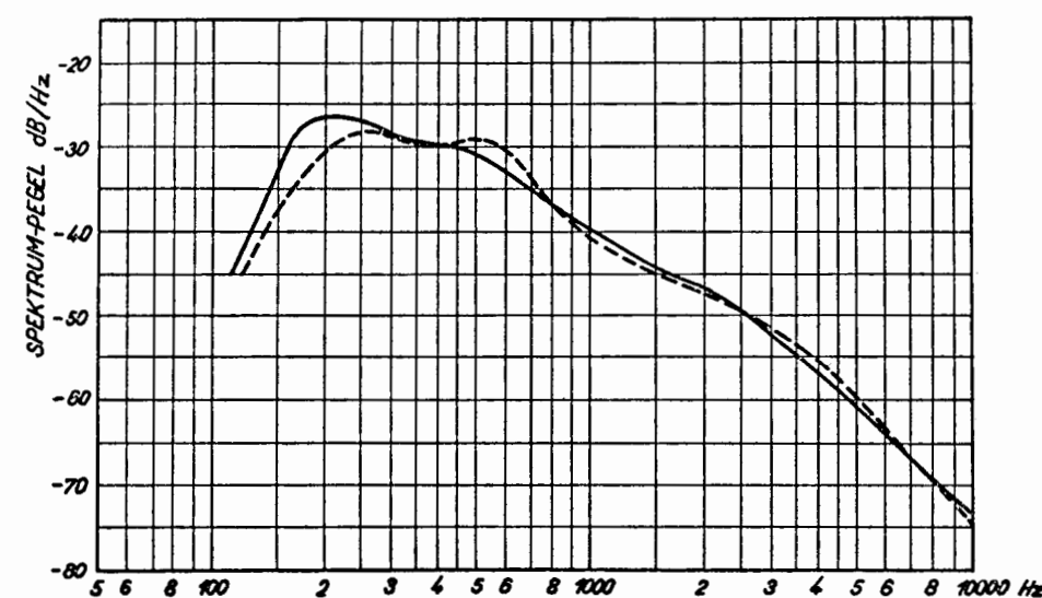
Abb. 5. Das Sprachspektrum der 1. Frauensprache (ausgezogene Kurve) und das durchschnittliche normale weibliche Sprachspektrum (gestrichelte Kurve) in relativen dB/Hz-Werten.
