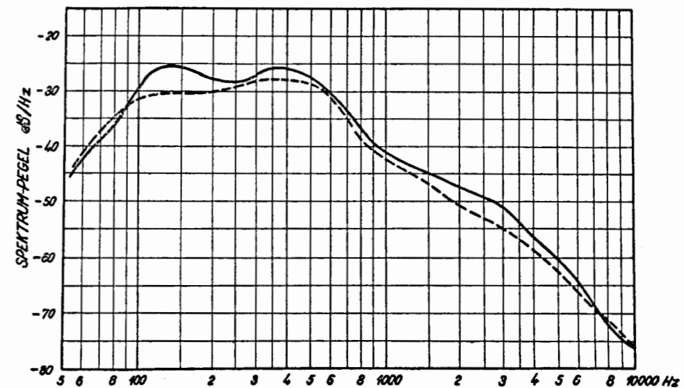
Abb. 2. Das Sprachspektrum der 1. Männersprache (ausgezogene Kurve) und das durchschnittliche normale männliche Sprachspektrum (gestrichelte Kurve) in relativen dB/Hz-Werten.
