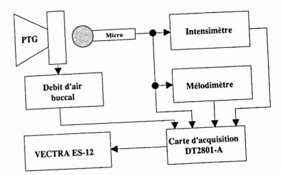
Figure 1: Schéma de principe de la chaine d'acquisition.
