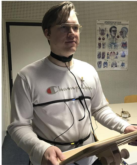
**Abbildung 1** – Vp im schallbehandelten Raum vor der Aufnahme der ersten Bedingung und nach der Verkabelung des EGG-Bandes, des Mikrophons und der beiden RIP-Gurte.
